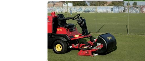
**Tondeuse hélicoïdale triple cylindres**
